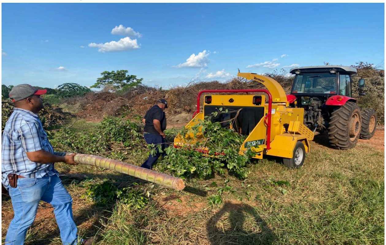
Foto 17. Operação de trituração de podas de galhos realizada pela Prefeitura e permitindo a reaplicação do material. Fonte: Prefeitura Municipal de Sagres
