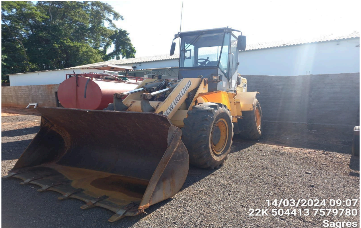
Foto 32. Pá-carregadeira utilizada na gestão do aterro em valas e em processos de coleta de resíduos sólidos urbanos.
