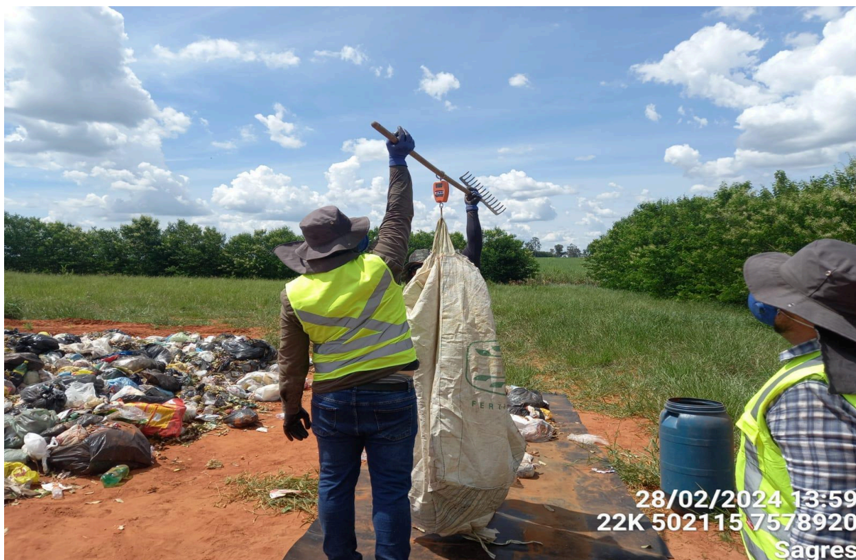
Foto 28. Pesagem das amostras com auxílio de big bags . Fonte: GLOBAL Projetos e Meio Ambiente
