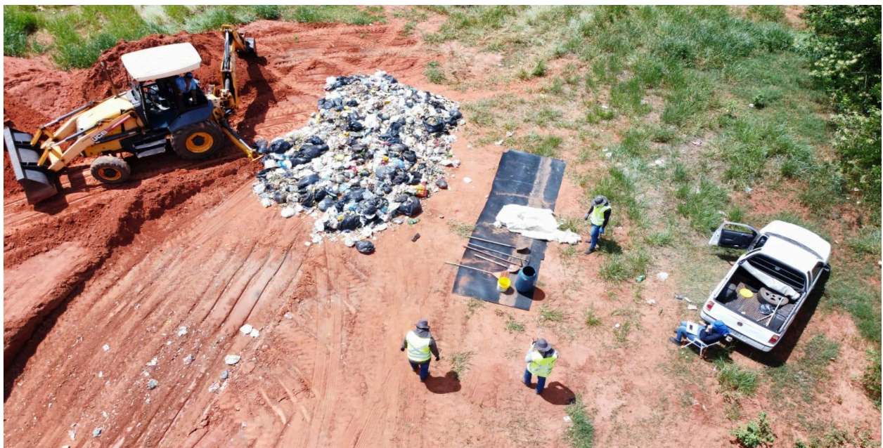
Foto 26. Pilha de resíduos homogeneizada para definição do quarteamento e retirada das amostras.
